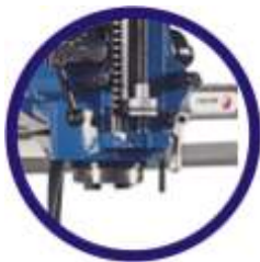
Eixo Árvore - ISO 40, diâmetro 100mm, revestimento de cromo duro, equipado com rolamentos de alta precisão classe P-4
